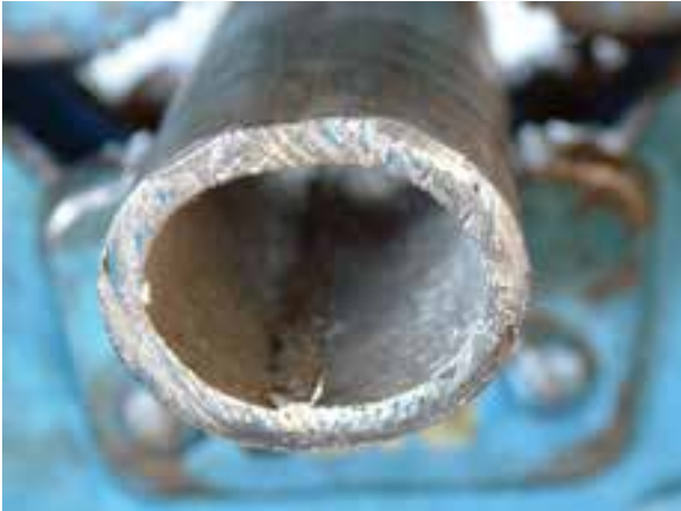
شکل ۱-۶۱- لوله‌ی دو پهن شده
