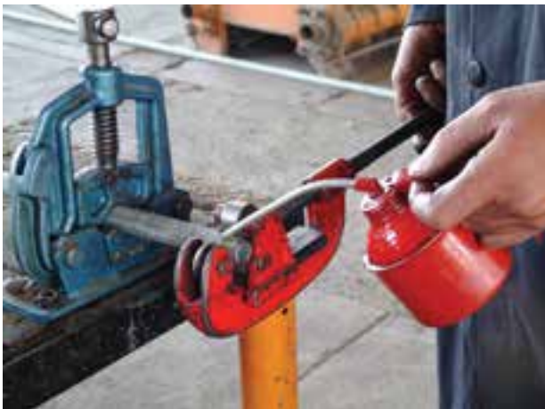
شکل ۱-۵۷- ریختن روغن در محل تماس
