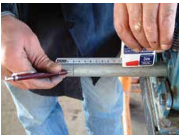
شکل ۱-۵۳ - مشخص کردن محل برش
