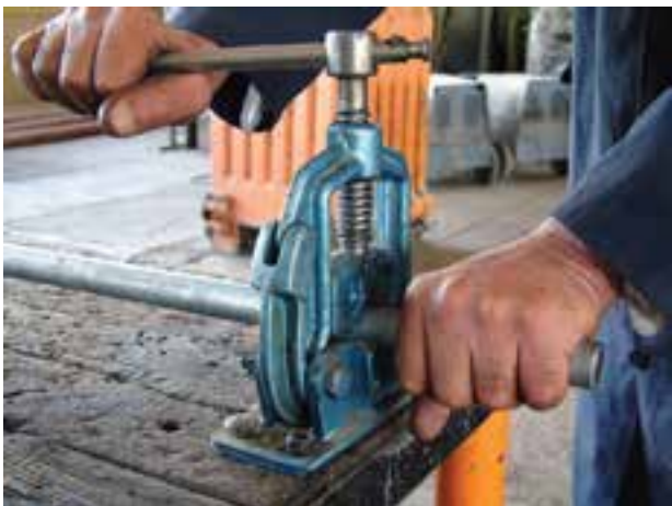
شکل ۱-۳۵ - بستن لوله به گیره برای ارّه کاری
