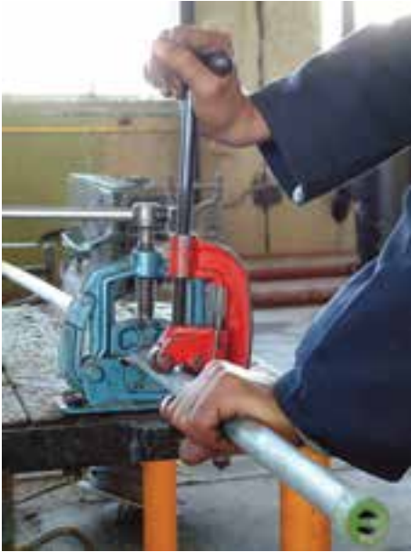
شکل ۱-۵۸- ادامه‌ی عمل بُرش‌کاری
