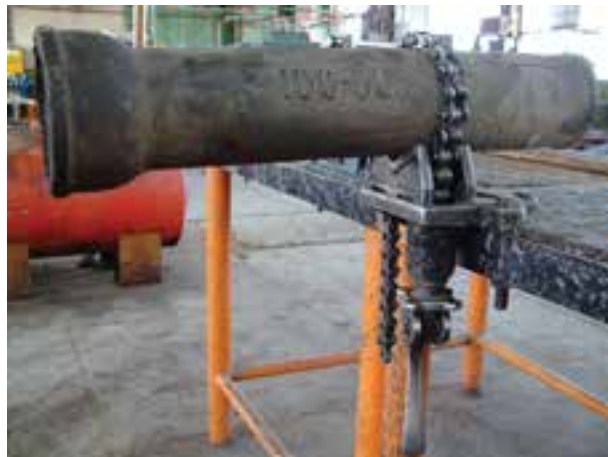
شکل ۱-۳۴- بستن لوله به گیره‌ی زنجیری
