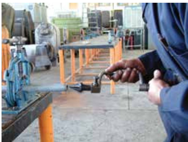
شکل ۲-۱۸- قرار دادن برقو در داخل لوله‌ی بسته شده به گیره
