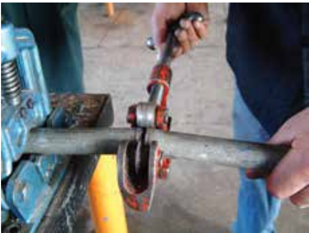
شکل ۱-۵۹- انتهای عمل بُرش‌کاری
