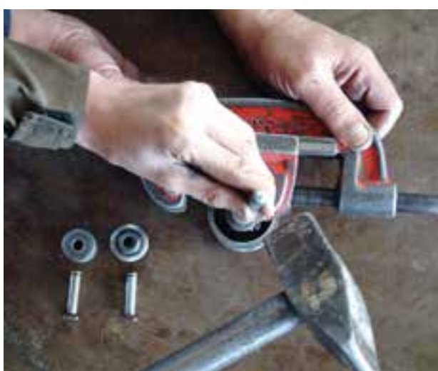
شکل ۱-۱۹- خارج کردن بین‌ها به وسیله‌ی سنبه‌نشان و چکش فلزی
