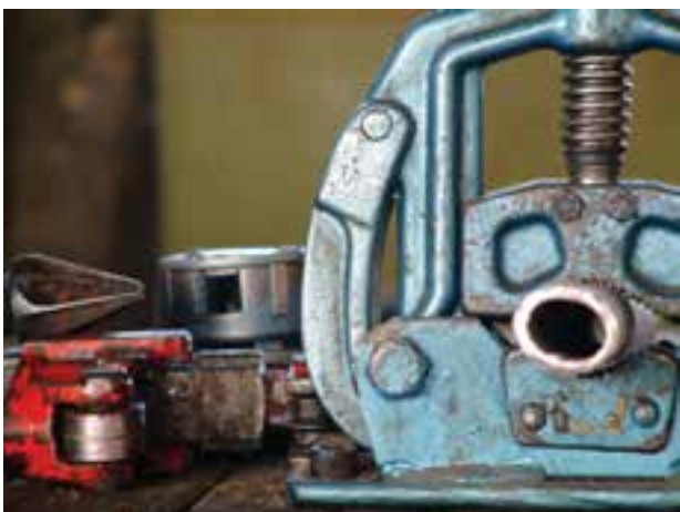
شکل ۲-۱۶- لوله‌ی دو پهن شده
