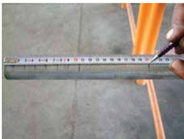
شکل ۱-۶۴-۱ خط کشی کردن لوله
