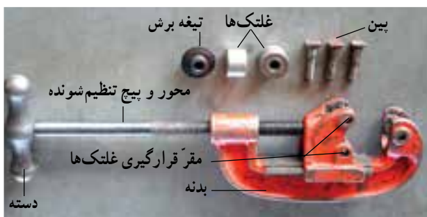
شکل ۱-۱۸- اجزای لوله بر دستی
