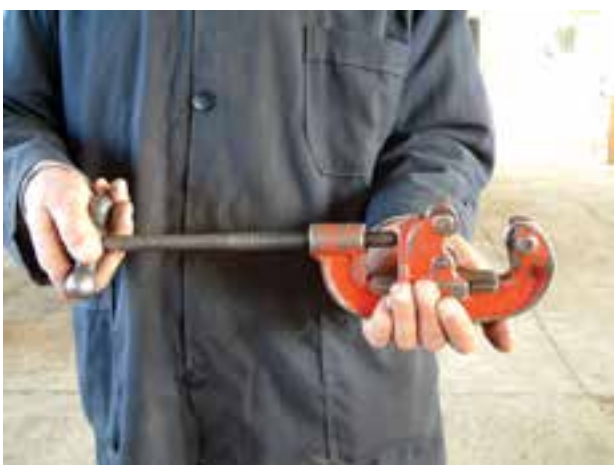
شکل ۱-۵۴ - باز کردن دهانه‌ی لوله‌بر
