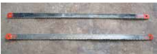
شکل ۱-۴۰ - از بین رفتن دندان‌های تیغه اژه
