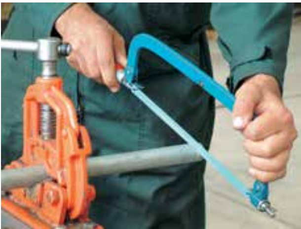
شکل ۵۰-۱- عدم رعایت فاصله‌ی مناسب از لب گیره
