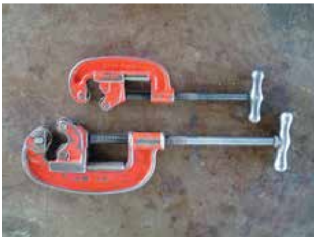
شکل ۱-۶۳- لوله‌بر در دو اندازه‌ی متفاوت
