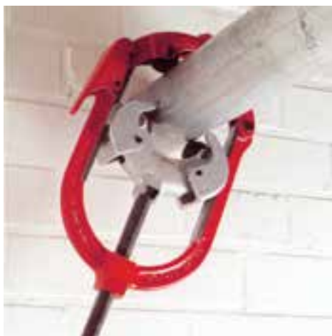
شکل ۱-۲۳- لوله‌بر دستی چهار تیغه
