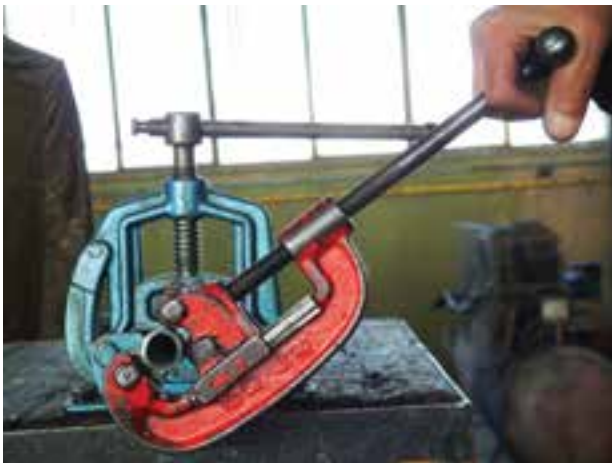
شکل ۱-۵۶- گرداندن لوله‌بر به دور لوله
