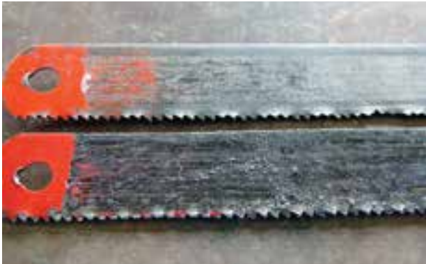
شکل ۱-۴۷- تیغه اره‌های دندان‌های شکسته شده
