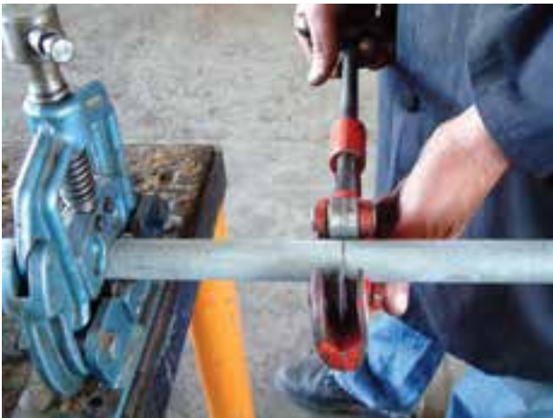
شکل ۱-۶۲- سفت کردن دسته‌ی لوله‌بر به اندازه‌ی لازم
