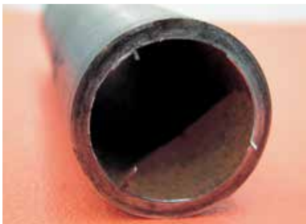
الف - لوله‌ی بریده شده به وسیله‌ی لوله‌بر
