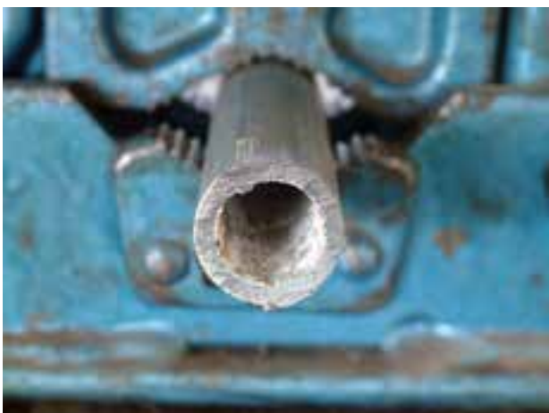
شکل ۱-۵۲ - لوله‌ی بسته شده به گیره‌ی لوله
