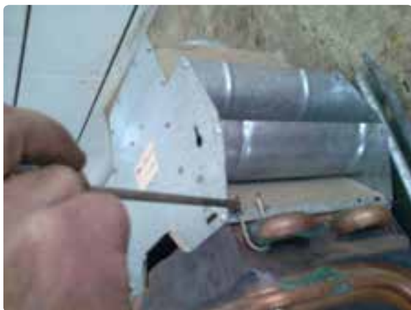
شکل ۶-۱ جدا کردن کلاهک تعدیل از مبدل
