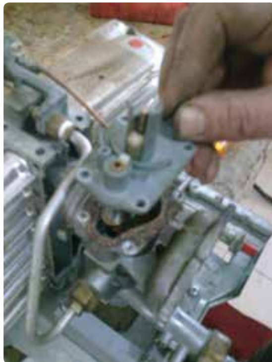
شکل ۱-۲۰- رگولاتور گاز بر روی آب گرم کن
