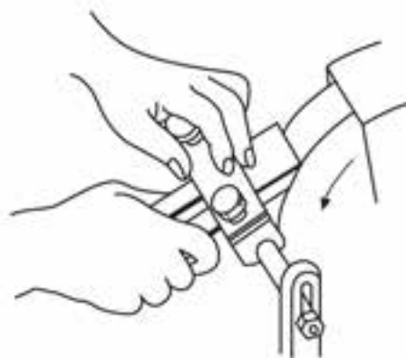
شکل ۱۴-۲۴- تیزکردن تیغه رنده با سنگ سنباده.
