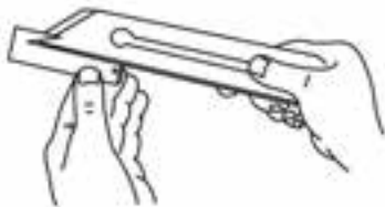
شکل ۱۴-۴۱. آزمایش تیزی تیغه رنده.
