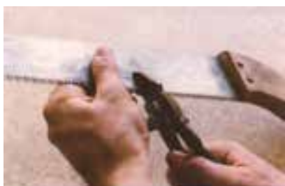
شکل ۱۴-۵۴-۱. فم کردن بقیه دندانها به طرف پایین.
