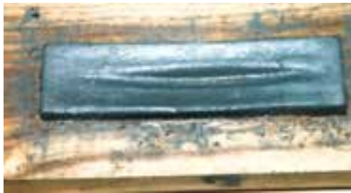
شکل ۴-۱۴- استفاده‌ی نادرست از سنگ نفت.
