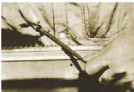
شکل ۱۴-۲۲- تیزکردن ارّه با استفاده از سوهان.
