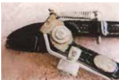
شکل ۱۴-۵۵-۱. تنظیم انبر چپ و راست کن با پیچ‌های مفصوم.
