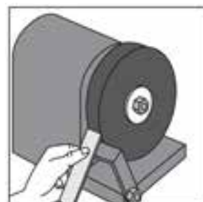
شکل ۱۴-۴۴ تنظیم تکیه‌گاه سنگ سنباده.
