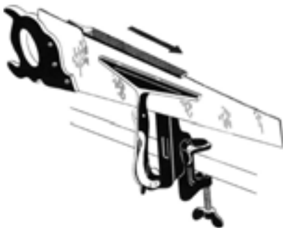
شکل ۱۴-۶۲- میزان کردن دندان‌های اره به وسیله سوهان.
