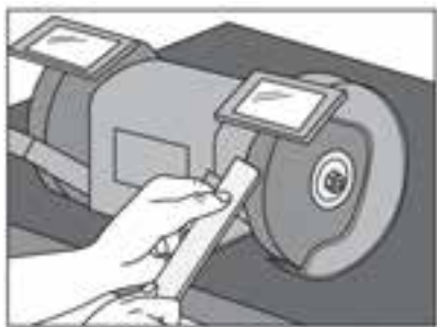
شکل ۱۴-۴۵ قرار دادن تیغه روی تکیه‌گاه.
