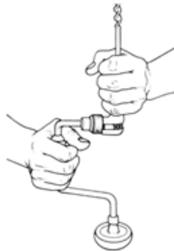
شکل ۱۲-۴۱- بستن و ممک کردن سر مته در داخل دریل.
