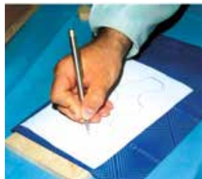
شکل ۱۱-۳۲- انتقال طرح از طریق کاربن.
