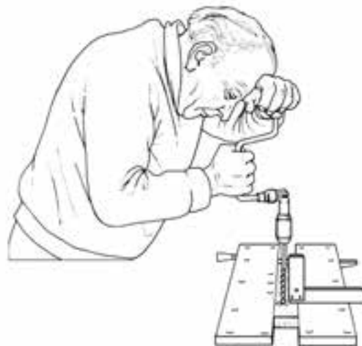
شکل ۱۲-۴۲- قرار دادن نوک دریل (روی قطعه کار) و کنترل آن با گونیا.
