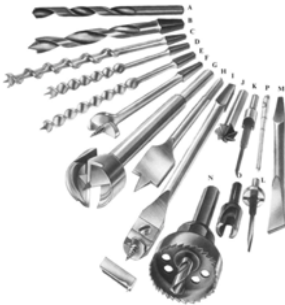
شکل ۱۱-۱۲- انواعی از سر مته‌های مخصوص چوب.
