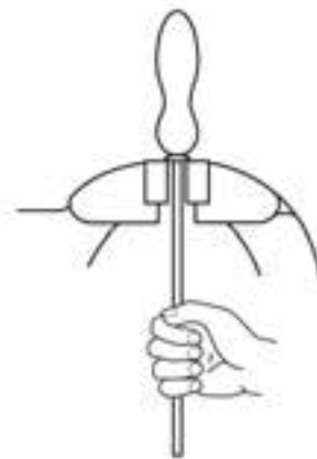
شکل ۱۱-۲۱- روش درآوردن سوهان از دسته.
