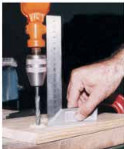
شکل ۱۲-۴۷- آزمایش گونیايي قرار گرفتن دریل.
