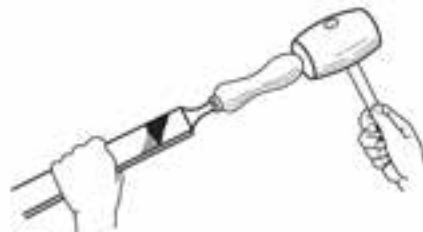
شکل ۱۱-۲۰- شکل جا زدن دسته‌ی چوب‌سا و سوهان.
