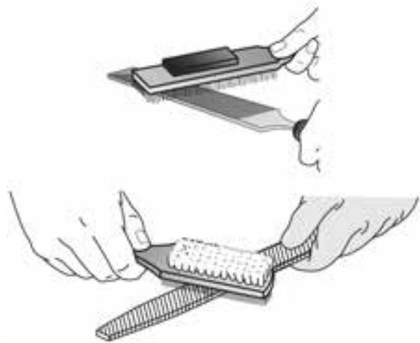
شکل ۱۱-۲۹- تمیز کردن سوهان با برس.
