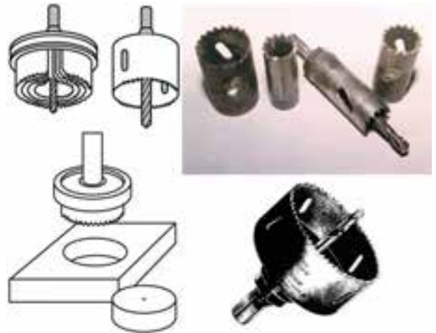
شکل ۱۲-۲۸- سر مته‌ی گردبر و کاربرد آن.
