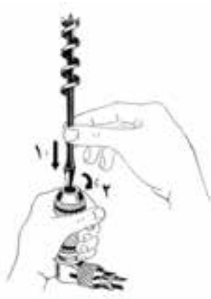
شکل ۱۲-۳۵- بستن سر مته به دریل.
