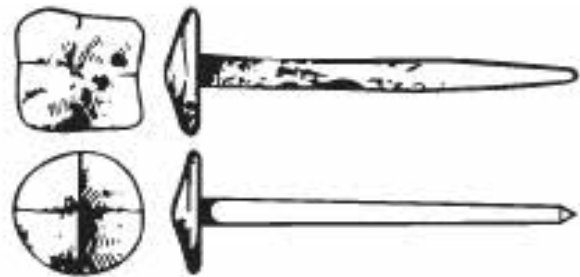
شکل ۱-۱۳- میخ کوره کاری شده.
