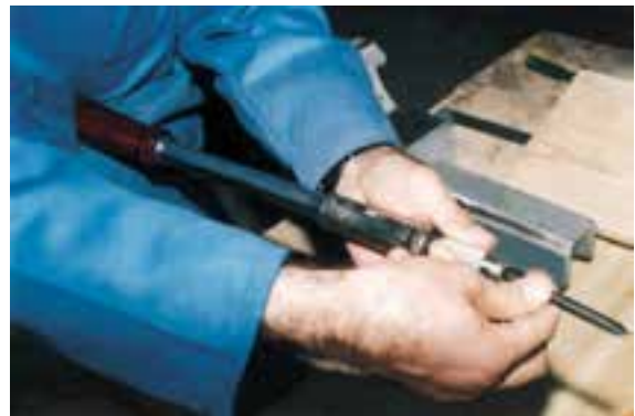
شکل ۸-۱۲- ممکن کردن نوک دریل فشاری.
