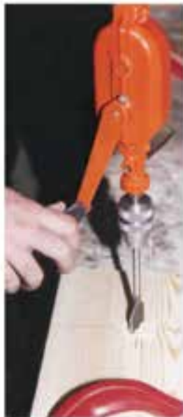
شکل ۱۲-۴۶- قرار دادن نیش.
