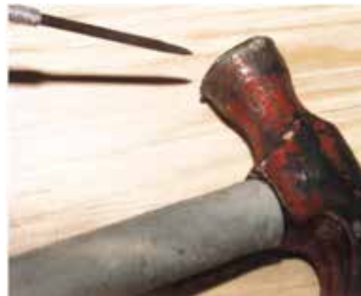
شکل ۷-۳۹- پلیسه‌ی ایجاد شده در سر چکش.
