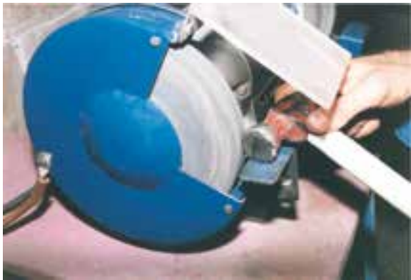
شکل ۷-۴۰- گرفتن پلیسه به وسیله‌ی سنگ سنباده.
