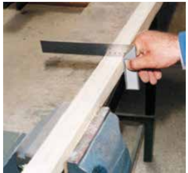
شکل ۶-۸۵- صمت گونیايي بودن قطعه کار با گونیا.
