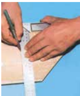
شکل ۶-۱۰۳- استفاده از گونیا برای خط‌کشی.
