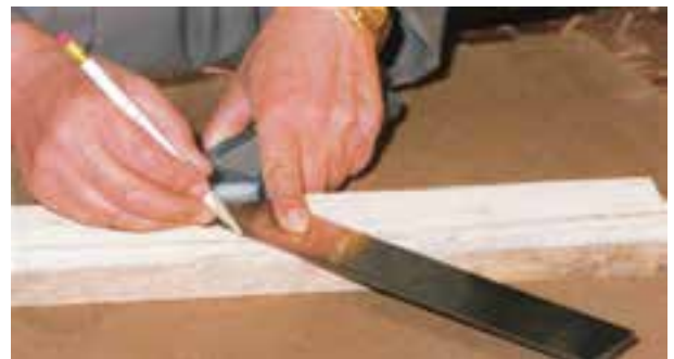
شکل ۶-۹۳- کار کردن با گونیای فارسی.
