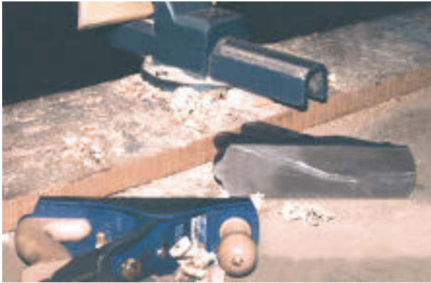
شکل ۶-۹۱- قرار دادن رنده در گودی میز کار.
