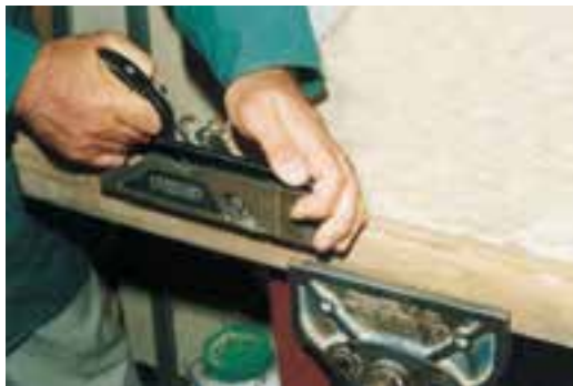
شکل ۶-۷۹- به کارگیری رنده بغل بدون گونیا.
