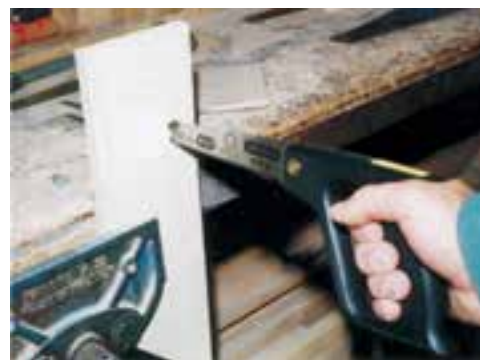
شکل ۵-۵۹- نمونه‌ی ایجاد سوراخ به‌وسیله‌ی اره نوکی.
