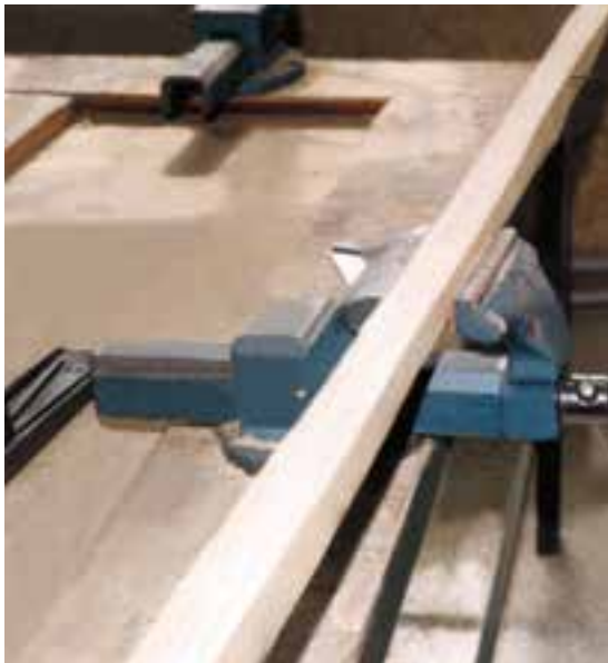
شکل ۸۳-۶. بستن قطعه کار به گیره میز کار.
