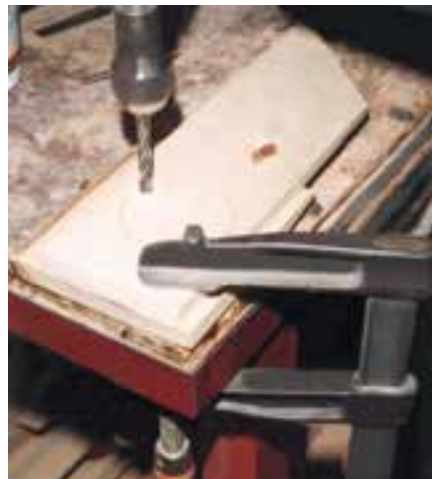
شکل ۵-۵۸- ایجاد سوراخ در قسمت داخلی قطعه کار.
