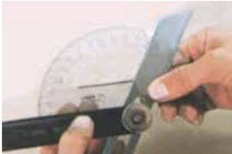
شکل ۱۰۰-۶- استفاده از نقاله در گونیا‌یی تاشو.
