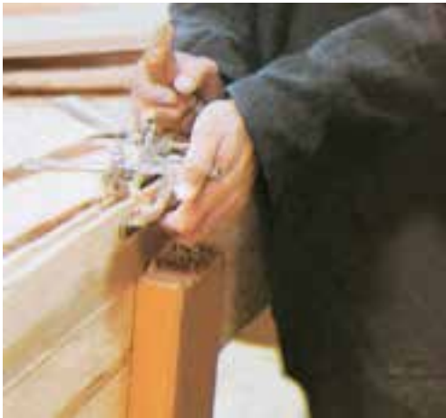
شکل ۸۲-۶. چگونگی کار با رنده کنشکاف.
