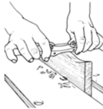
شکل ۶-۴۴- نمونه‌ی رندیدن قوس‌های دافلی.
