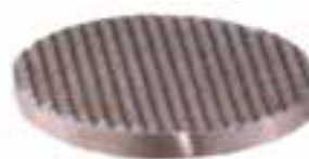
شکل ۷-۲۴- آج روی سر چکش.
