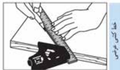
شکل ۶-۱۰۶- خط‌کشی طولی با گونیا‌ی مرکب.
