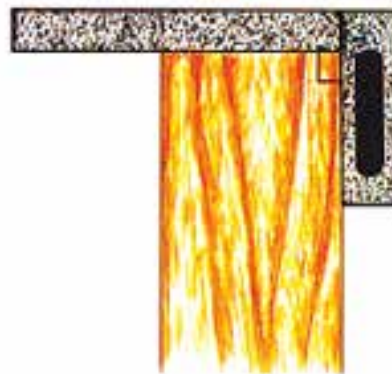
شکل ۹۸-۶- کنترل گونیا‌یی بودن قطعه کار.
