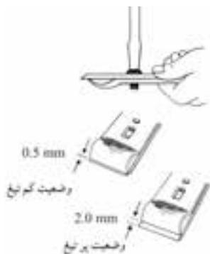
شکل ۶-۶۵- تنظیم و محکم کردن تیغه و پشت بند.
