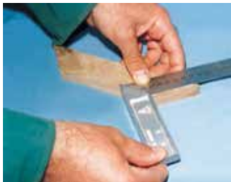
شکل ۵-۶۵- کنترل گونیایی بودن قطعه کار.
