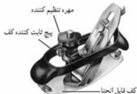
شکل ۶-۴۶- قسمت‌های مختلف رنده کاس و سینه.
