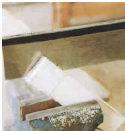
شکل ۵-۵۵. مالت افقی ارّه در پایان برش.
