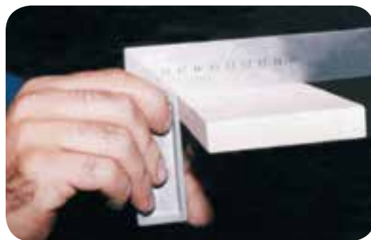
شکل ۶-۷۴- آزمایش صمت رنده‌کاری با گونیا
