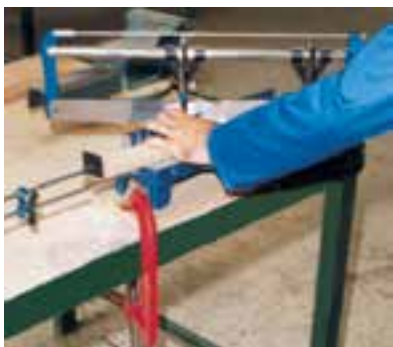
شکل ۵-۶۴- ایجاد برش ۴۵ درجه به وسیله‌ی اژه فارسی‌بُر.
