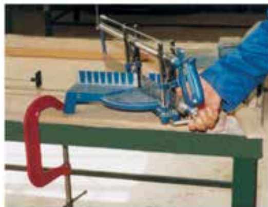
شکل ۵-۶۳- قرار دادن اژه روی زاویه‌ی موردنظر به کمک اهرم تنظیم.
