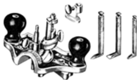
شکل ۶-۴۱ (رنده‌ی کف طرح فرنگ همراه تیغه‌ها).
