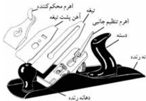
شکل ۶-۱۶- قسمت‌های مختلف رنده فلزی (دو تیغه).
