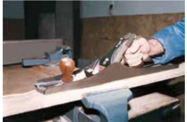
شکل ۶-۸۴- استقرار رنده بلند (دستگاه).
