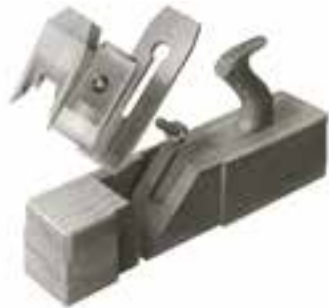
شکل ۱۴-۶. با انداختن تیغه‌ی رنده پوچی.
