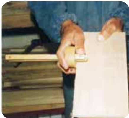
شکل ۶-۷۷- فطاکشی روی چوب با فطاکش تیره‌دار.
