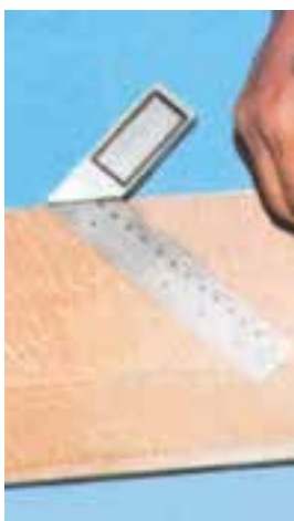
شکل ۶-۱۰۴- خط‌کشی فطوط ۴۵ درجه به وسیله‌ی گونیای معمولی.
