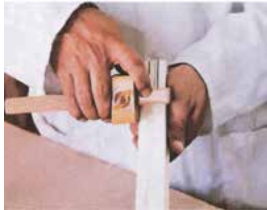
شکل ۵-۵۴. مُطابقتی با استفاده از مُطابکش تیزه‌دار.
