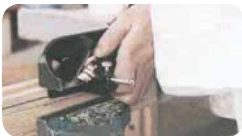
شکل ۶-۷۸- به کارگیری رنده بغل قابل تنظیم.
