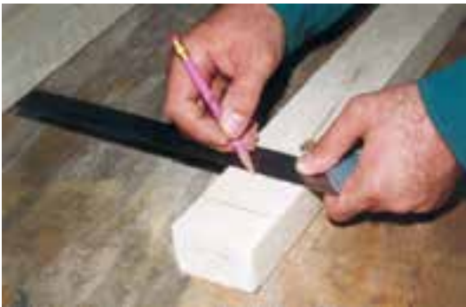
شکل ۵-۴۸- فم‌کشی قطعه کار به‌وسیله‌ی گونیا و مداد.
