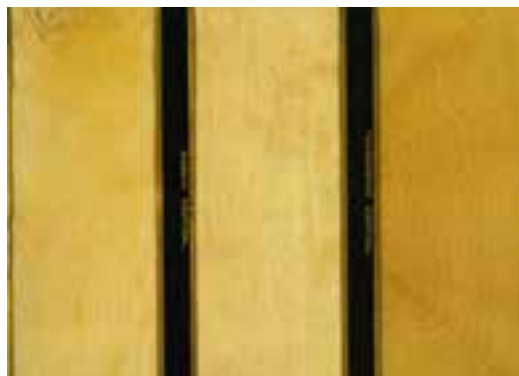
شکل ۳-۲۰. برش‌های عرضی، شعاعی و مماسی چوب مَمَرز
