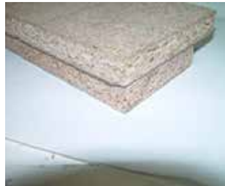
شکل ۳-۱۴۵- تخته فرده چوب با لایه‌های تدریجی.
