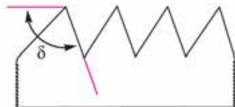
شکل ۵-۳۳- زاویه‌ی برش \delta بیشتر از ۹۰ درجه.
