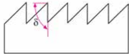
شکل ۵-۳۲- زاویه‌ی برش \delta مساوی ۹۰ درجه.
