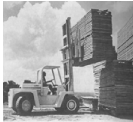
شکل ۳-۳۹- جابجایی دسته‌بندی به وسیله‌ی لیفت‌تراک.
