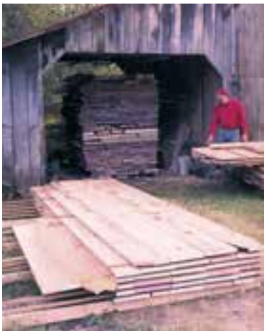
شکل ۳-۱۴- هانگار چوب فشک‌کنی.
