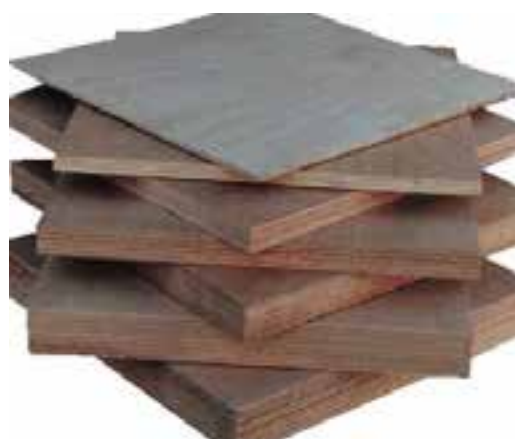
شکل ۳-۴۸ - انوع تخته پندلایه، با ضخامت‌های متفاوت.
