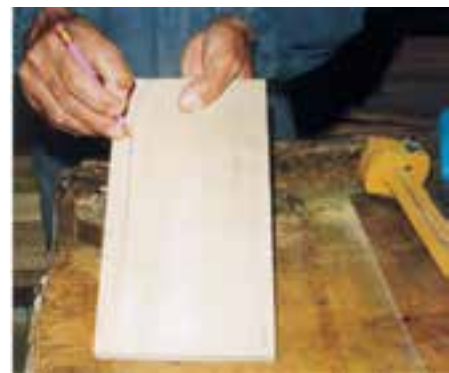
شکل ۵-۴۲- پررنگ کردن فصوص با مداد.
