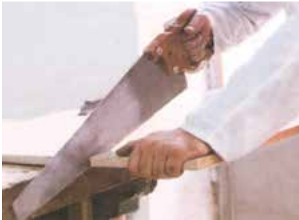
شکل ۵-۸- نمونه‌ی برش به وسیله اژه دُم (روباهی).
