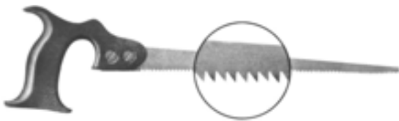
شکل ۵-۱۳- اره نوکی، با بزرگنمایی دندان‌ها.
