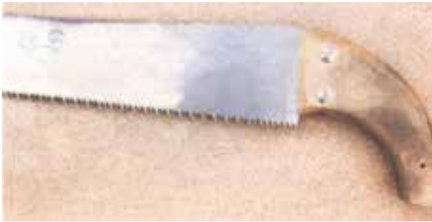
شکل ۵-۳- اره‌ی دندانه‌رو به عقب.
