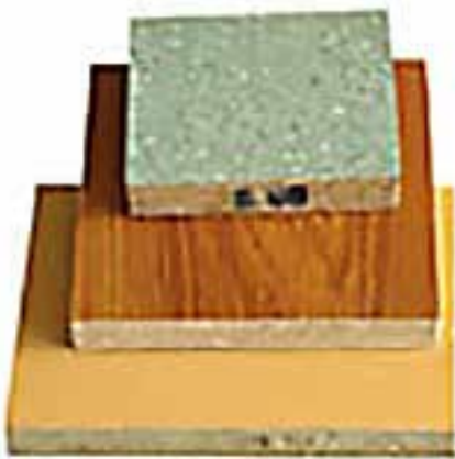
شکل ۳-۱۴۶- تخته فرده چوب با روکش مصنوعی.
