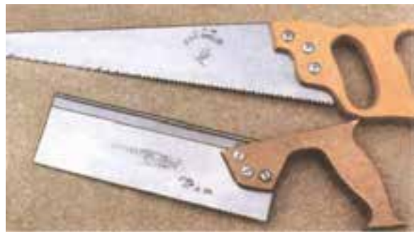
شکل ۵-۲- اره‌های دندانه‌رو به جلو.
