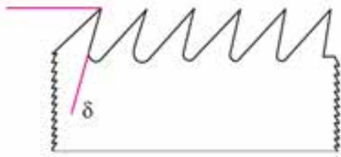
شکل ۵-۳۴- زاویه‌ی برش، کمتر از ۹۰ درجه.
