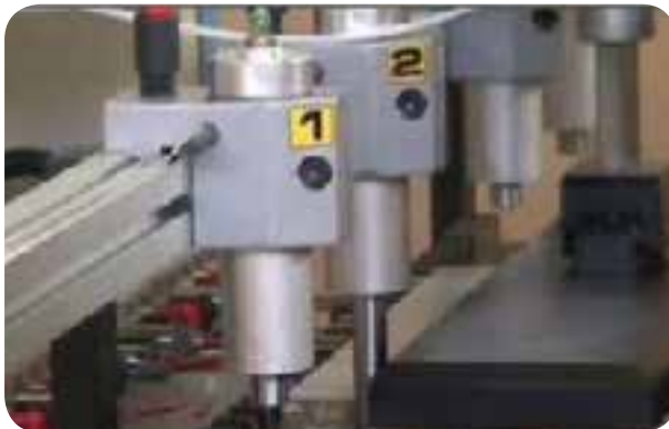
شکل ۳-۷ قطعه کار، توسط جک‌ها گونیا شده است.
