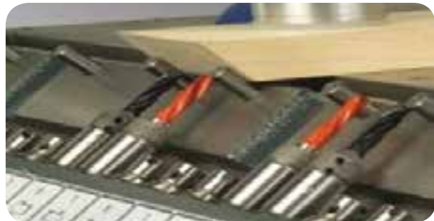
شکل ۳-۵ سوراخ کاری قطعات زاویه دار
