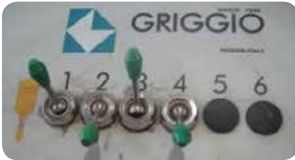
شکل ۳-۶ کلیدهای بالا و پایین بُرنده جک‌ها
