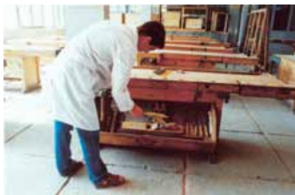
شکل ۲-۱۱- تمیز کردن دافل جمعیه ابزار میز کار.
