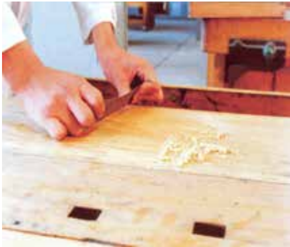
شکل ۲-۱۷- تمیز کردن سطح میز کار با لیسسه.
