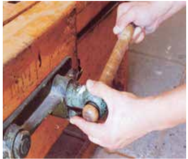
شکل ۲-۱۸- ضامن باز و بسته کردن آزاد گیره.
