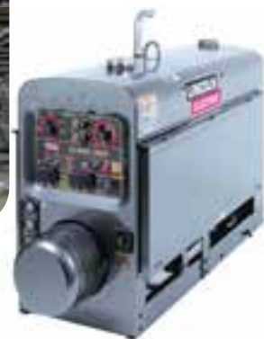
ج) دستگاه‌های جوشکاری نظیر: رکتیفایر، ترانس، دینام و موتور جوش ادامه - برخی از دستگاه‌های موجود در کارگاه‌های جوشکاری
