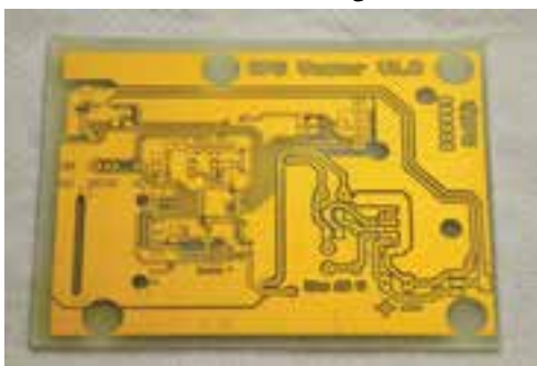
شکل ۷-۱۵ پهنای خطوط مدار چاپی متناسب با جریان عبوری از قطعات
