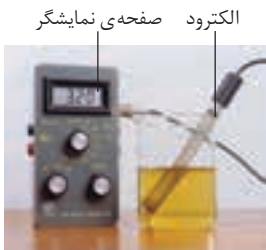
شکل ۳ یک pH سنج دیجیتالی. محلول درون بشر اسیدی یا قلیایی است؟
