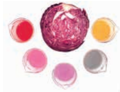
شکل ۴ آب کلم سرخ به عنوان یک شناساگر اسید-باز عمل می کند. محلول های نشان داده شده از چپ به راست pH های ۱، ۴، ۷، ۱۰ و ۱۳ دارند.
