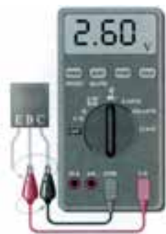
شکل ۱۲-۴۹ ترانزیستور معیوب (قطع)
