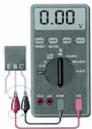
شکل ۱۲-۵۰ ترانزیستور معیوب (اتصال کوتاه)
