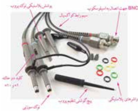
شکل ۵-۶ پروب و اجزای آن
