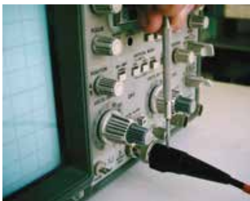
شکل ۸-۶ نحوه‌ی تنظیم پروب
