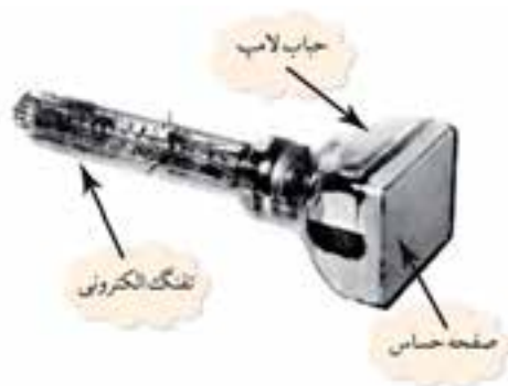
شکل ۲-۶ شکل ظاهری یک لامپ اشعه کاتدیک
