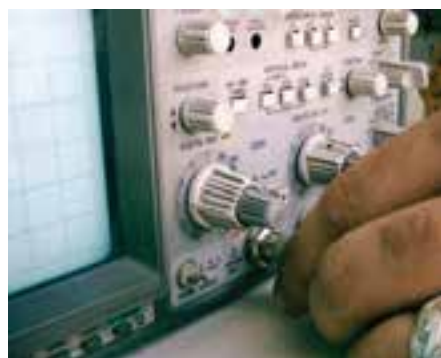
شکل ۶-۶ نحوه‌ی اتصال BNC به اسیلوسکوپ
