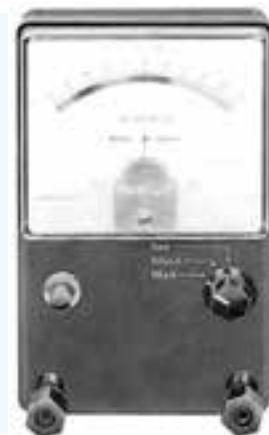
شکل ۳-۲۶- یک نمونه گالوانومتر صفر وسط
