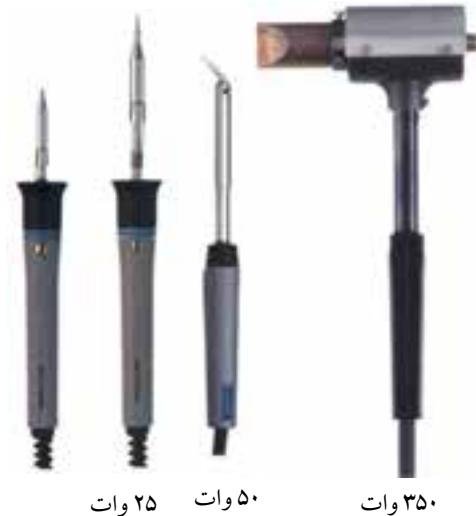
شکل ۳-۳۶ چند نمونه هویه
