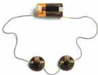
شکل ۲۹-۲ مدار واقعی دو لامپ به صورت سری
