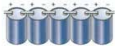
شکل ۲-۱۲۰ اتصال سری پیل‌ها
