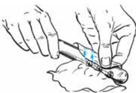
شکل ۱-۱۳ باردار کردن اجسام از طریق اصطکاک
