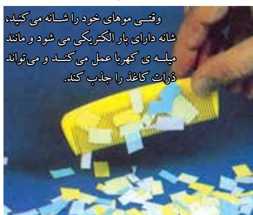
شکل ۱-۱ یکی از روش های تولید الکتریسیته
