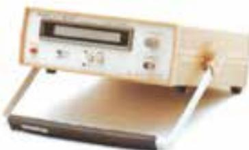
شکل ۱-۵۴ یک نمونه LC متر
