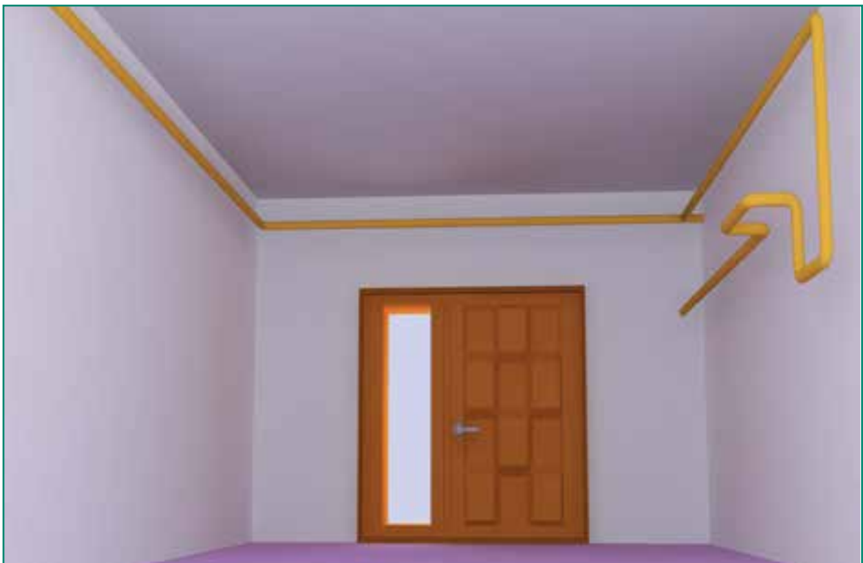
شکل ۴-۲۳ الف نمایش مسیر لوله‌ها در داخل راهرو
