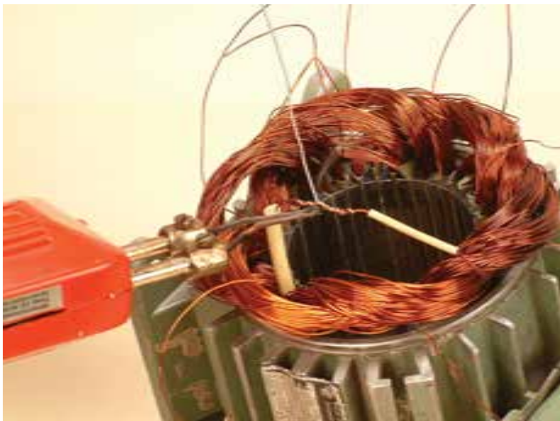
شکل ۳-۸- محل اتصال دو سیم را لحیم کنید.
