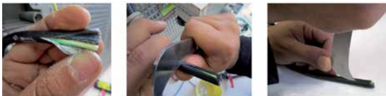
شکل ۲-۲۲ - بریدن و لخت کردن کابل
