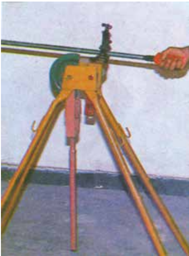
ج - پلیسه‌برداری داخل لوله توسط برقو
