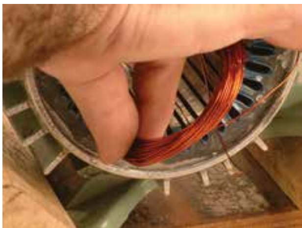
شکل ۲-۱۵- قراردادن بازوی شماره یک در شیار شماره ۱
