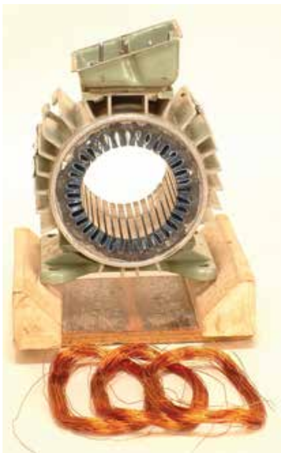
شکل ۲-۱۴- تعیین محل قرار گرفتن کلاف ها
