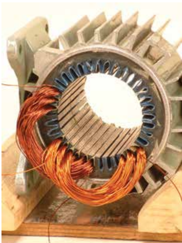
شکل ۲-۲۲- شروع گروه کلاف سوم از شیار شماره ۱۳
