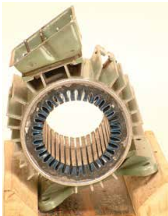
شکل ۲-۱۳- انتخاب شیار شروع و مسیر کلاف‌گذاری
