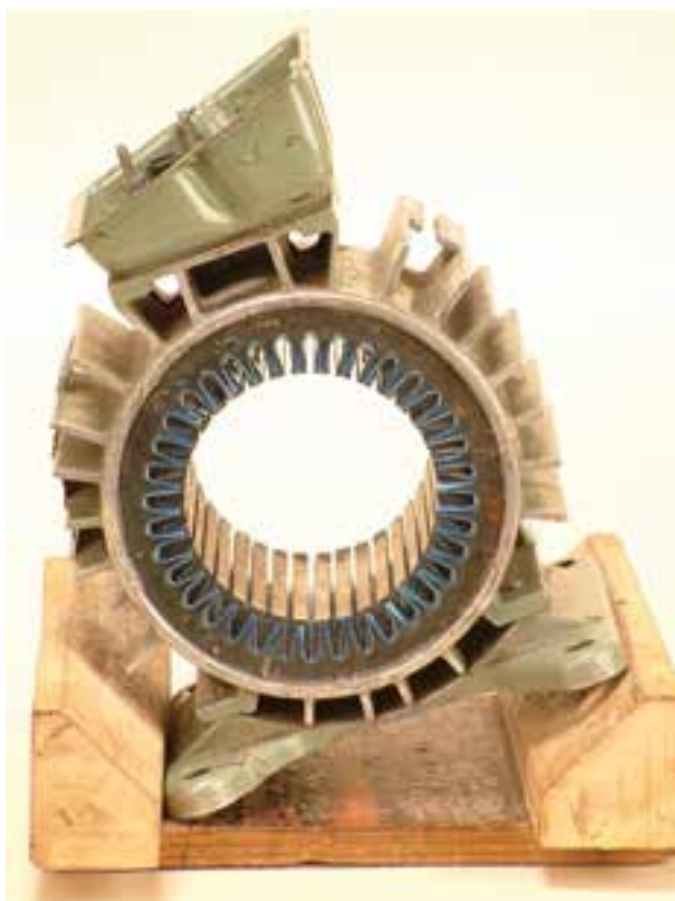
شکل ۲۹-۲-ب - انتخاب شیار شروع سیم‌بندی
