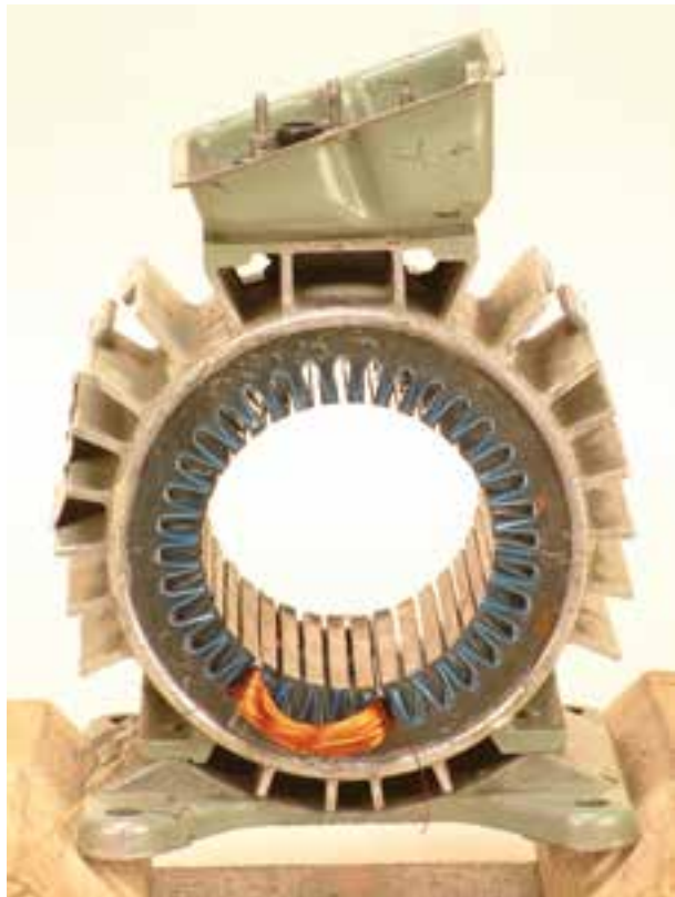
شکل ۲۹-۲-ج - قراردادن کلاف شماره ۱
