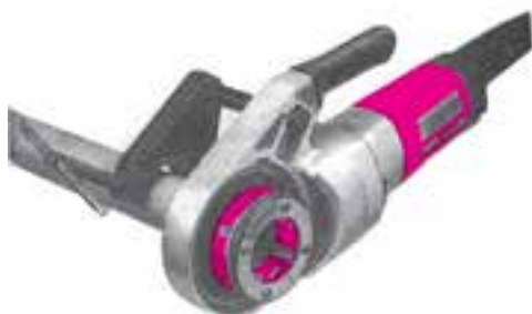
ب - دستگاه حدیده هیدرولیکی شکل ۴-۱۱ - حدیده‌ی لوله فولادی
