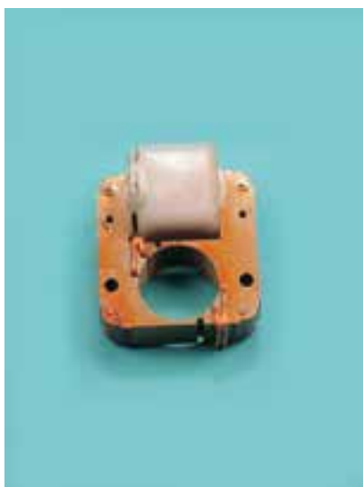
شکل ۲-۲- استاتور موتور قطب چاکدار
