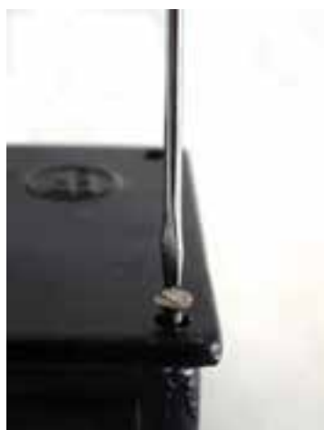
شکل ۲-۱۷- ابزار ناسالم و معیوب سبب خرابی سرپیچ می شود.
