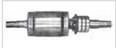
شکل ۱-۱۵ - شکل واقعی روتور سیم‌پیچی شده
