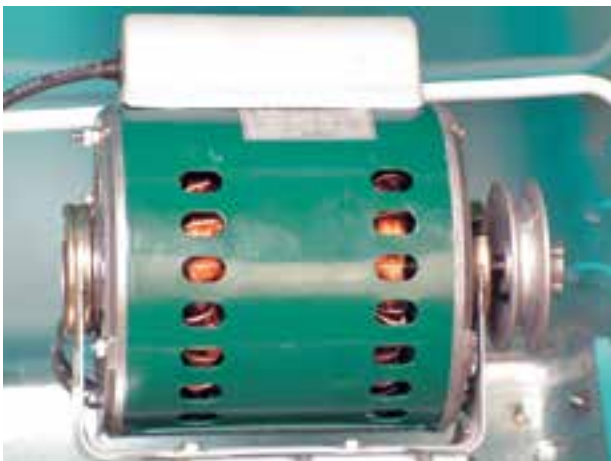
شکل ۱-۲۸- موتور تک فاز با راه انداز خازنی
