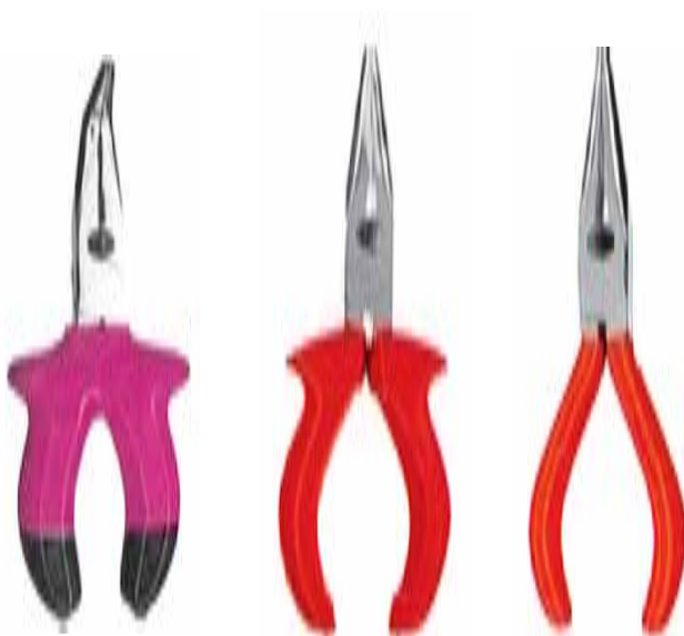
الف - دم باریک دسته ب - دم باریک دسته عایق ج - دم باریک دسته عایق عایق معمولی نوک گرد فشار قوی با نوک بلند فشار قوی با نوک کج ۴۵°
