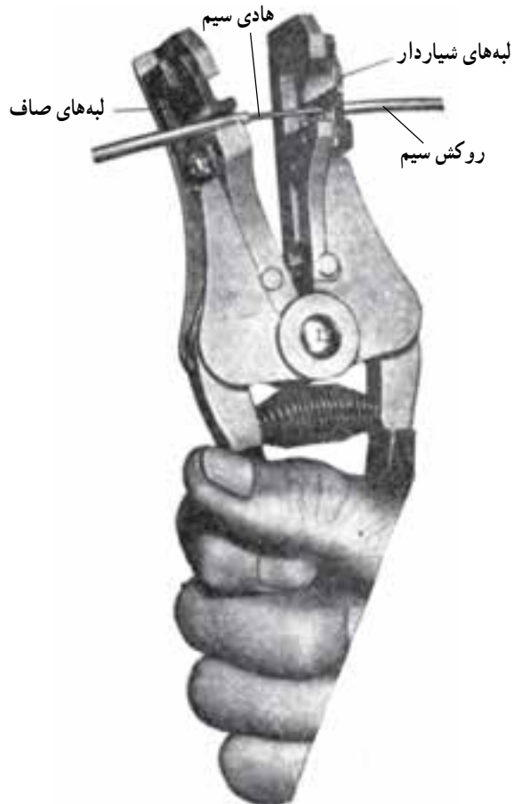
شکل ۹-۱- سیم لخت‌کن خودکار در حال روکش برداری
