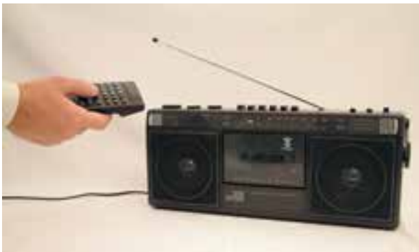
شکل ۳-۴۸- تست کنترل از راه دور توسط رادیو
