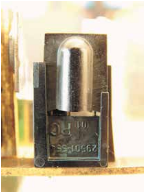
شکل ۱۴-۳- آی سی گیرنده مادون قرمز
