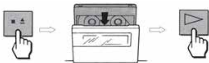
شکل ۵-۴۴- قرار دادن نوار آزمون در دستگاه ضبط و انتخاب حالت پخش صدا
