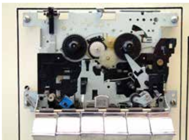
شکل ۳-۳۷- سیستم انتقال نوار با دکمه‌های فشاری
