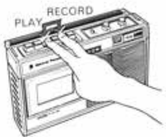
شکل ۴۳-۳ فشردن همزمان کلیدهای فشاری پخش (Play) و ضبط (Record)
