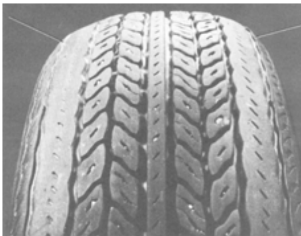
شکل ۲۱۴-۳- سایش در اثر رانندگی غلط (پیچیدن تند)
