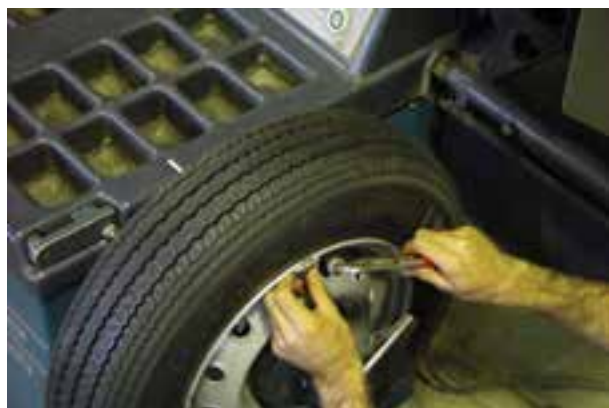
شکل ۲۳۸-۳- نصب وزنه روی قسمت بیرونی رینگ
