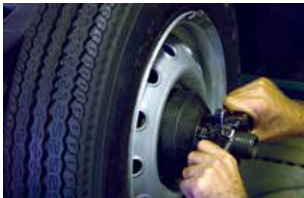
شکل ۲۳۴-۳- نصب چرخ روی دستگاه
