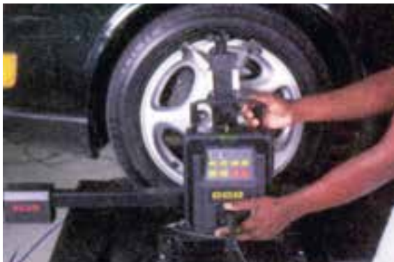
شکل ۲۲۰-۳ نصب مجموعه حسگر دستگاه اندازه‌گیر رایانه‌ای
