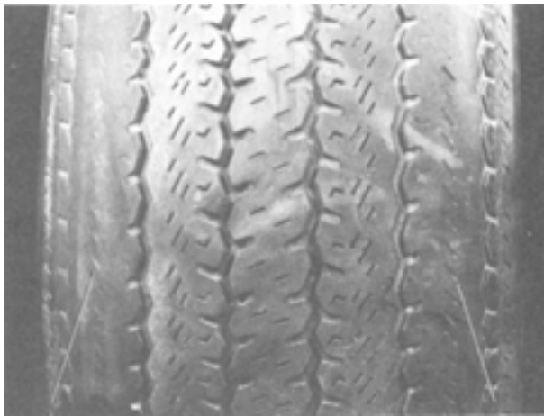
شکل ۲۱۶-۳- سایش در اثر تنظیم نبودن باد (باد کم)
