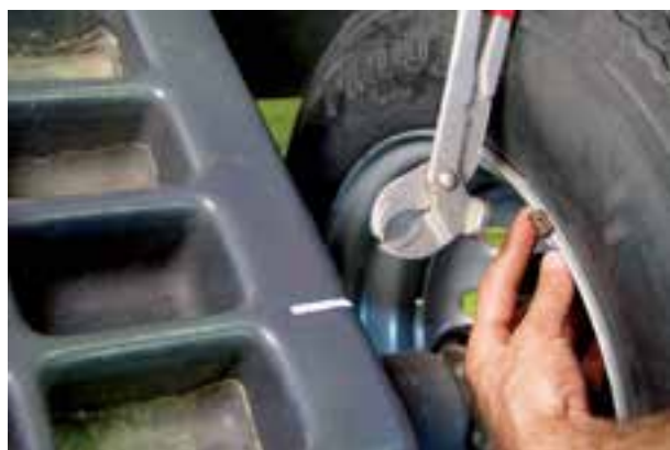
شکل ۲۳۹-۳- نصب وزنه روی قسمت داخلی رینگ
