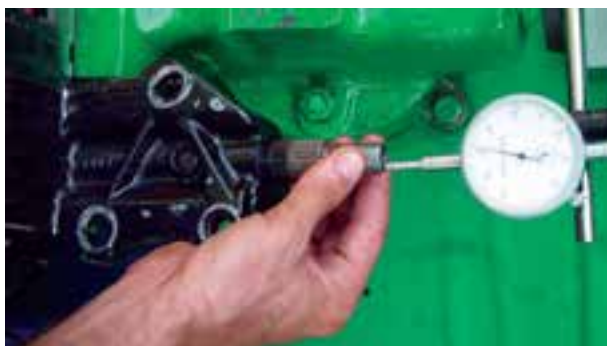
شکل ۷۰-۲- اندازه‌گیری لقی طول محور هزار خار
