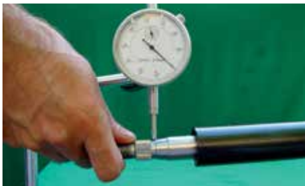
شکل ۶۹-۲- اندازه‌گیری لقی جانبی میل فرمان
