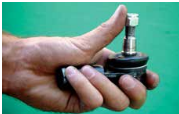
شکل ۸۴-۲- کنترل لقی سیبک‌ها
