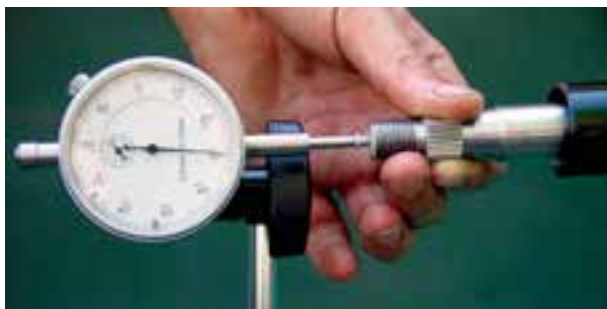
شکل ۶۸-۲- اندازه‌گیری لقی طولی میل فرمان
