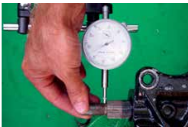
شکل ۷۱-۲- اندازه‌گیری لقی جانبی محور هزار خار
