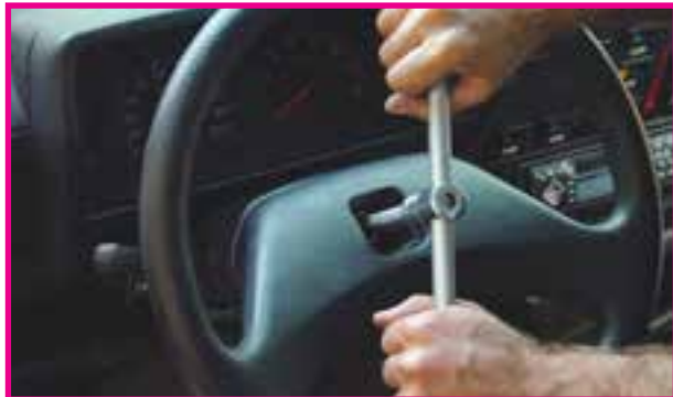
شکل ۲-۳۳- پیاده کردن فلکه فرمان
