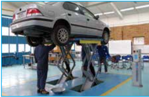
شکل ۲-۴۶- استقرار خودروی روی بالابر
