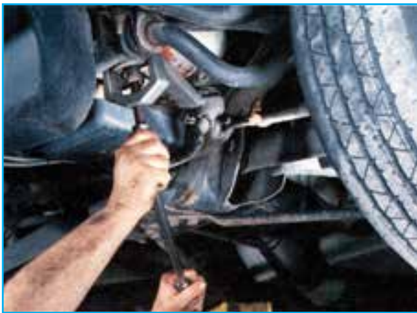
شکل ۲-۴۷- نحوه استفاده از نوعی سیبک کش
