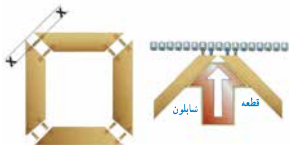
شکل ۲-۱۶- ب- روش ساخت اتصال قاب فارسی، به وسیله دوپل زن ماشینی
