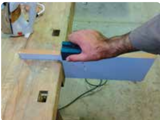
شکل ۱۵۶-۲ رنده پرداخت لبه نوار روکش لبه چسبان
