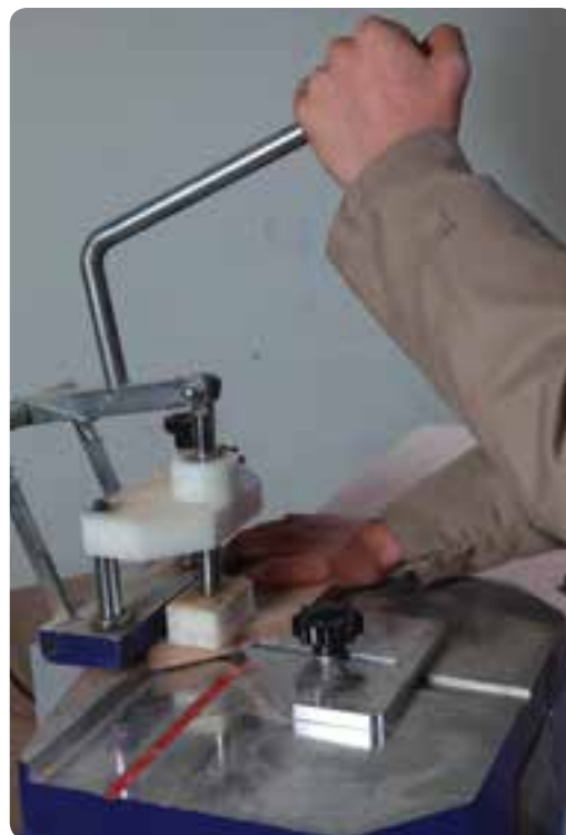
شکل ۲-۱۱۲ برش با زاویه ۴۵ درجه
