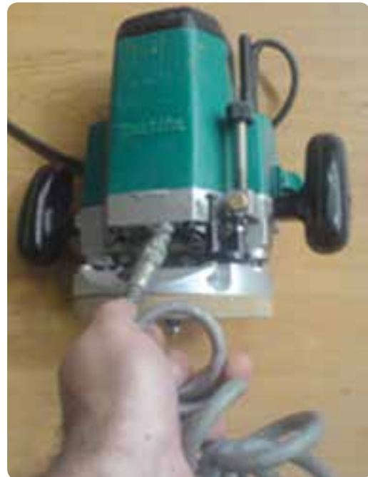
شکل ۲-۷۱ بادگیری دستگاه پس از پایان کار
