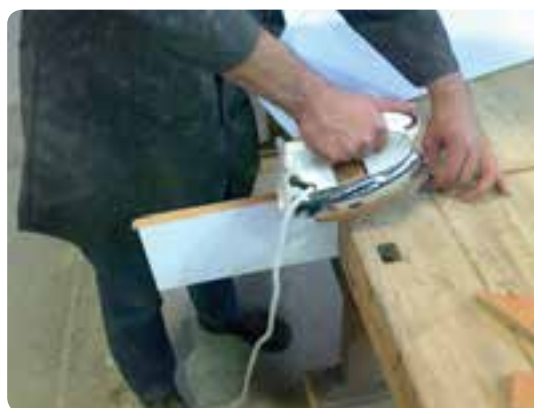
شکل ۱۴۷- اتوکشی نوار روکش لبه‌چسبان
