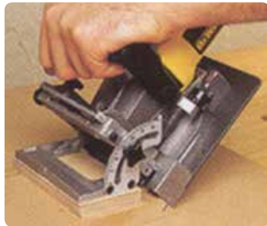
شکل ۲-۹۰ شیارزنی با زاویه ۴۵ درجه
