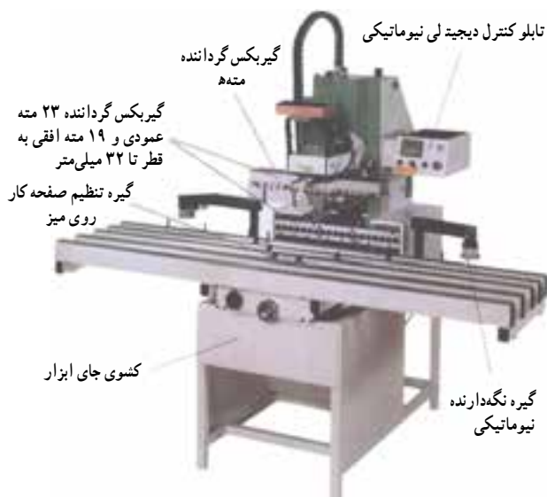
ماشین سوراخ‌زنی و لولازنی دیجیتالی نیوماتیک
