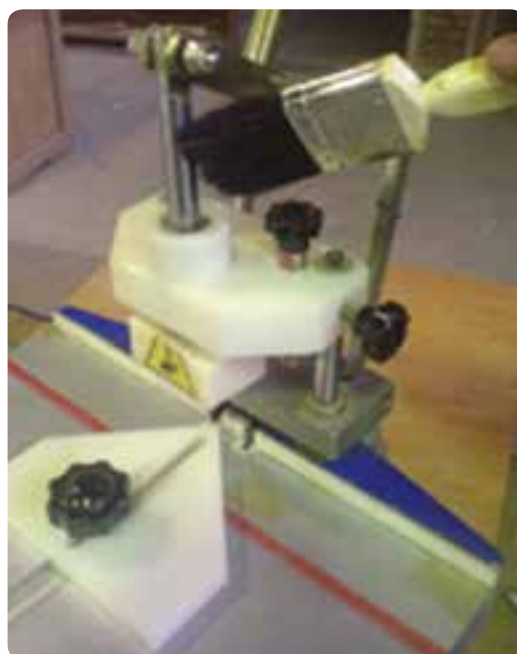
شکل ۱۱۶-۲ تمیز کردن مفصل‌های حرکتی ماشین دم چلچله‌زن
