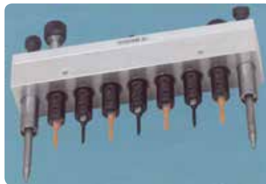
شکل ۲-۱۲۷ مجموعه متنه‌ها جهت سوراخ‌کاری عمودی
