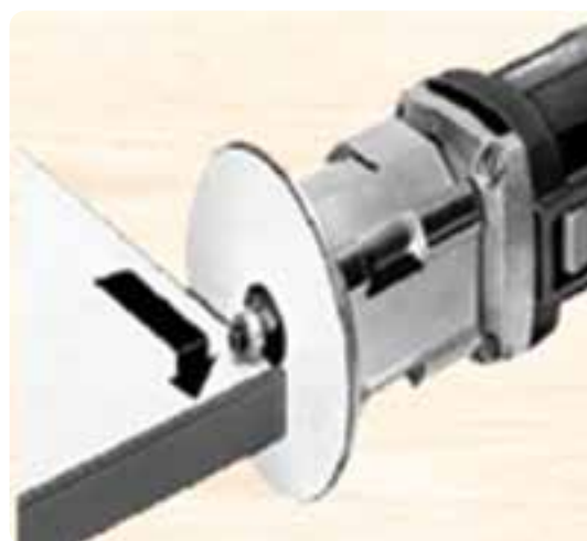
شکل ۱۵۵-۲ پرداخت لبه‌های اضافی روکش مصنوعی
