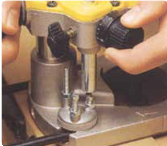
شکل ۲-۷۲ پیچ‌های تنظیم دستگاه
