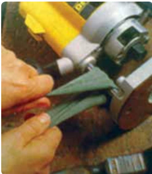
شکل ۶۶-۲ تمیز کردن میله‌های کشویی اورفرز
