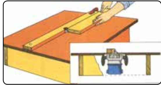
شکل ۶۲-۲ بکارگیری اورفرز در حالت میزی
