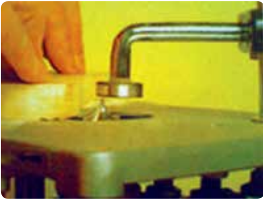
شکل ۶۵-۲ بلبرینگ هدایت برای قطعات قوس‌دار
