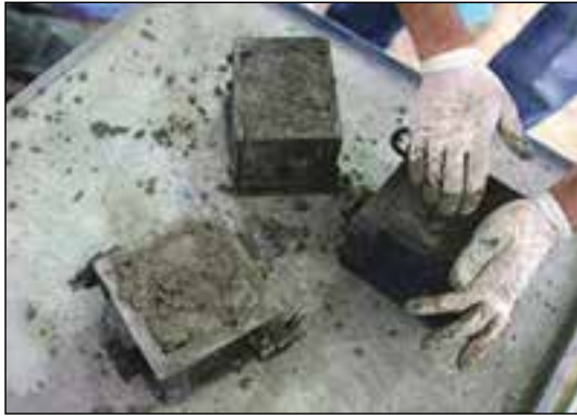
شکل ۱-۵۱ آزمایش مقاومت بتن
