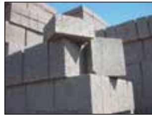
شکل ۷۹-۱ انواع بلوک بتنی سبک
