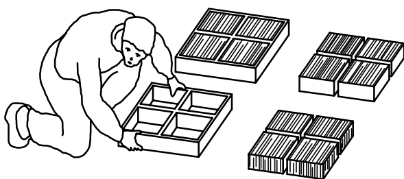
شکل ۵۶-۱ قالب زنی خمیر و ساخت خشت
