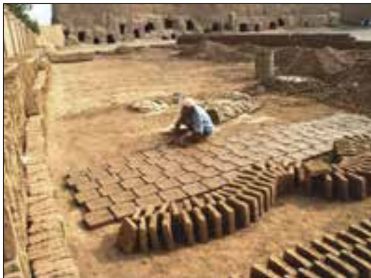
شکل ۱-۵۴ خشت خام (ساخت آجر به روش دستی)
