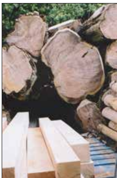
شکل ۱-۱۵۹ بالای تصویر گرده بینه - پایین تصویر الوار
