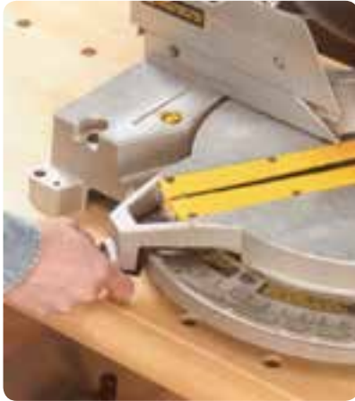
شکل ۲-۸ تنظیم زوایای مختلف برش
