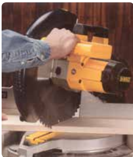
شکل ۲-۵ حرکت اهرمی در اره گرد فارسی بر
