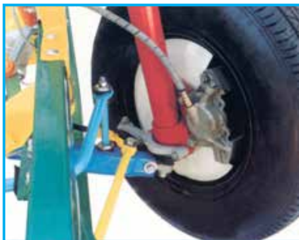
شکل ۱-۳۲- لوله مایع ترمز انعطاف پذیر
