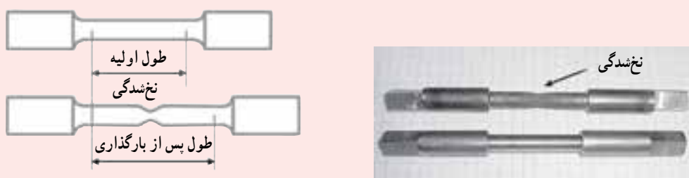
شکل ۲-۲۱- نمونه آزمایشی قبل از اعمال نیرو و پس از رسیدن به مرحله نخ شدگی
