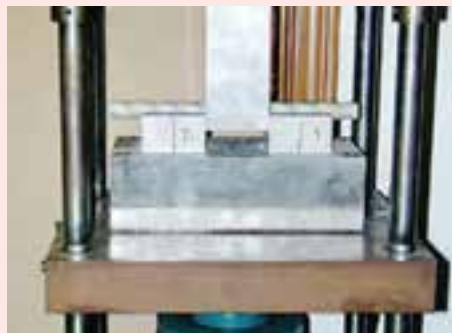
شکل ۷-۲۲- دستگاه آزمون استحکام کششی
