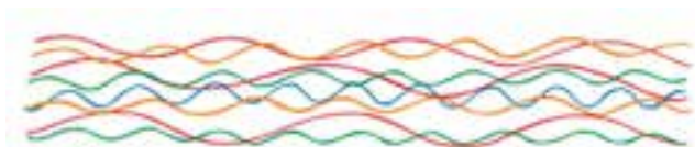
شکل ۳۲- نور سفید ناهمدوس حاوی امواج با بسامدها (و طول موج‌های) مختلف و ناهم‌فاز با یکدیگر است.
