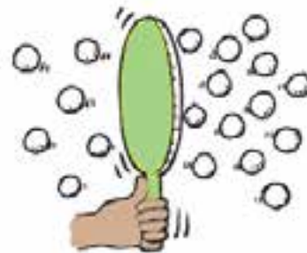
شکل ۳- راکت پینگ‌پونگی که در میان توپ‌های پینگ‌پونگ ارتعاش دارد سبب ارتعاش توپ‌ها می‌شود.
