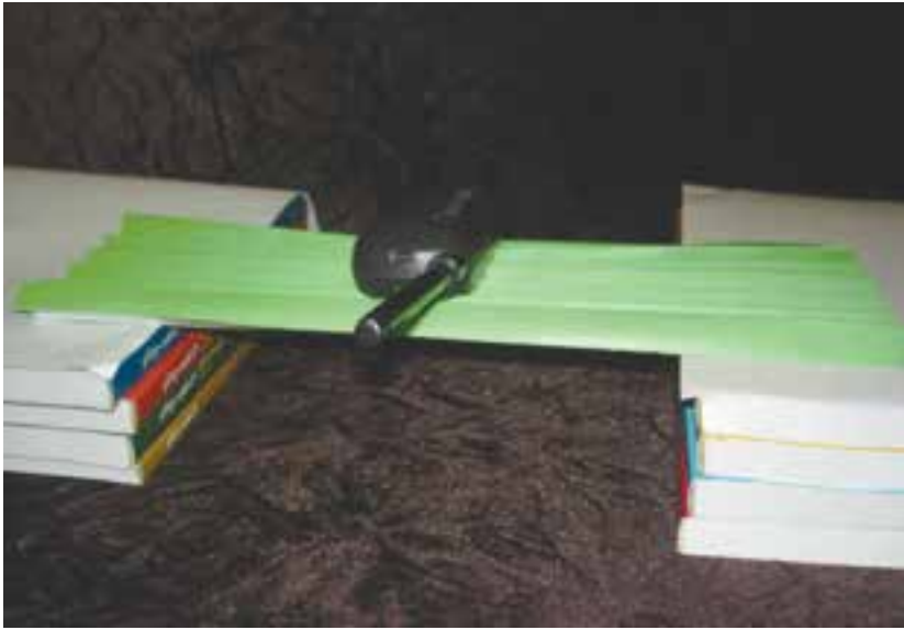
شکل ۴-۵- مقاومت خمشی پل در مقابل یک وزنه
