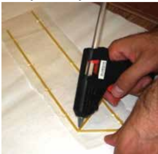
شکل ۲-۳- ساخت قاب جانبی سازه پل ماکارونی
