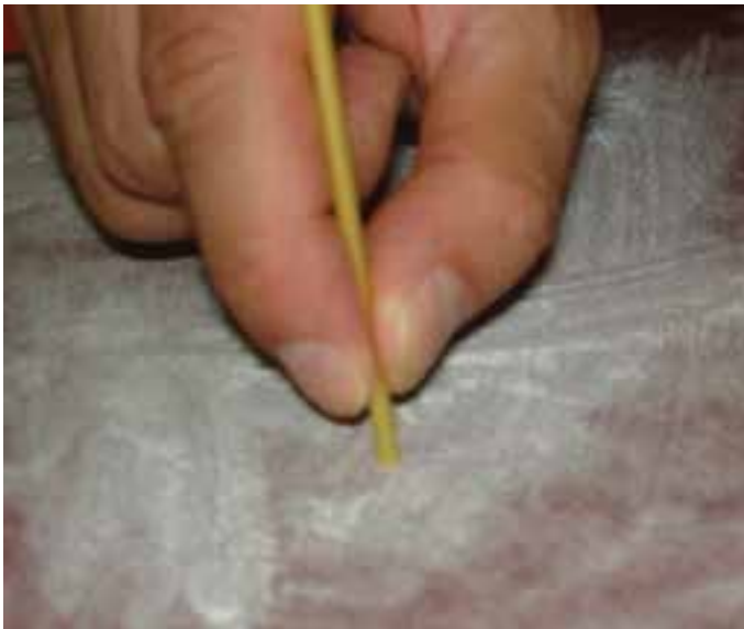
شکل ۲-۲- نحوه سنباده کردن و اندازه کردن ماکارونی
