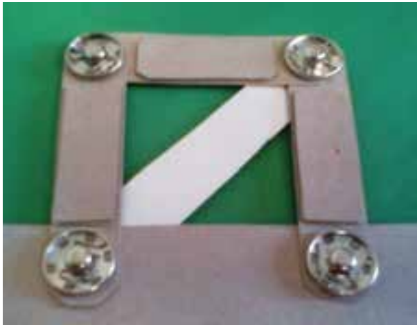
شکل ۶-۱- ماکت قاب ساختمانی ساده مهاربندی شده
