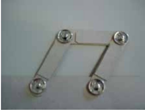
شکل ۵-۱- جابه‌جایی قاب ساختمانی ساده مهاربندی نشده
