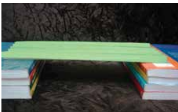
شکل ۲-۵- پل کاغذی با یک برگه A ۴ به صورت ۷ و ۸
