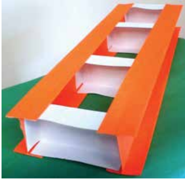
شکل ۵-۷- سازه پل کاغذی I شکل
