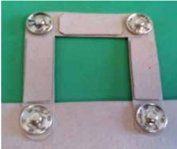
شکل ۱-۴- ماکتی از قاب ساختمانی ساده مهاربندی نشده
