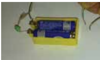
شکل ۲-۸- دو سر سیم رابط از هم جداست و LED خاموش است.
