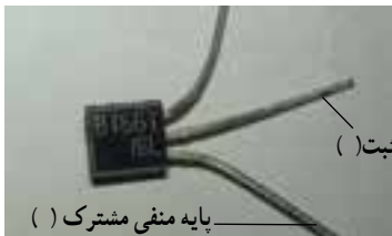
شکل ۱-۳- آ‌ی سی مولد ملودی زنگ UM۶۶ یا BT۶۶
