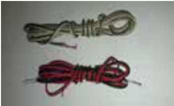
شکل ۱-۲- نمونه‌هایی از سیم افشان با قطر ۰/۲۵ یا ۰/۵ میلی‌متر
