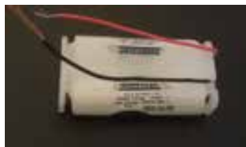
شکل ۱-۲- یک نمونه جای باتری قلمی ساده
