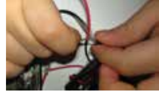
شکل ۱۱-۳ – برقراری اتصال سیم رابط با پایه مثبت آی‌سی
