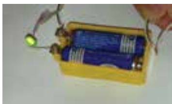
شکل ۹-۲- اتصال دو سیم، LED روشن می‌شود.
