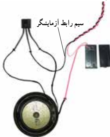
شکل ۳-۳- مدار عملی آزمایشگر مدار صوتی
