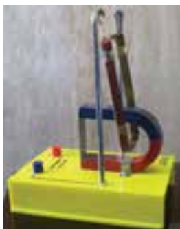
شکل ۵-۴- یک نمونه کامل با پایه به ترمینال‌های آبی و قرمز رنگ جهت اتصال قطب و باتری دقت کنید.
