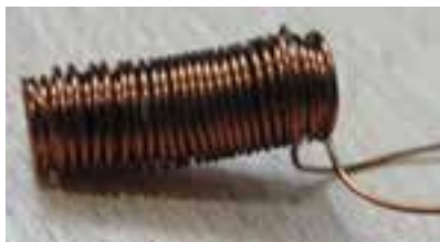
شکل ۳-۵- سیم پیچ دو لایه است .
