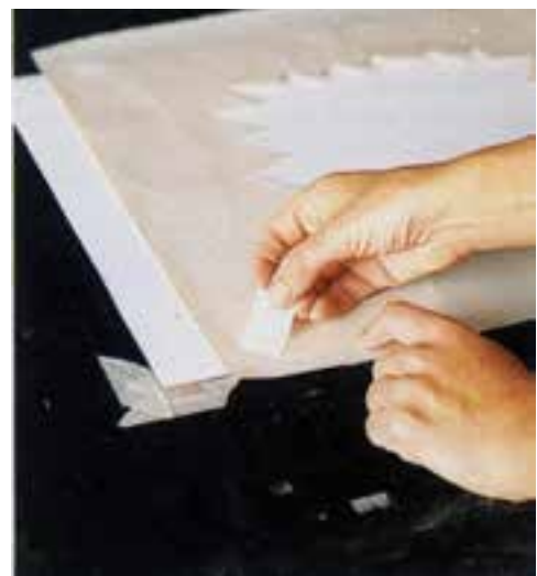
تصویر ۱۲۳- تنظیم کاغذ چاپ و استنسیل آماده شده برای مرحله چاپ
