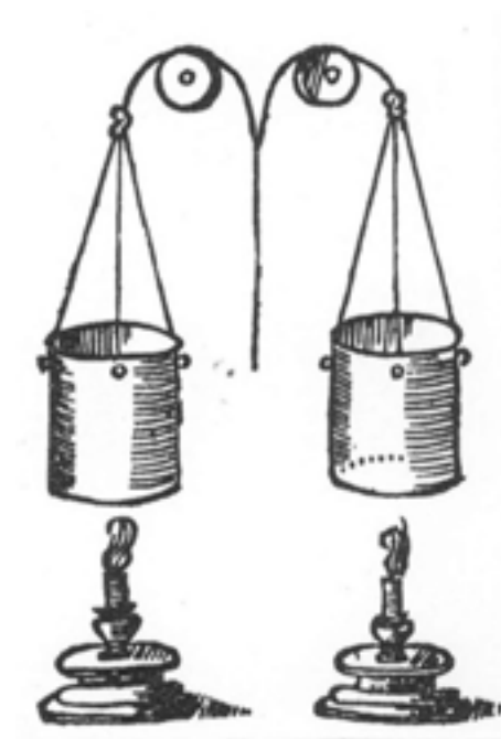
▲ شکل ۲۷-۲- وسیله‌ای برای کم کردن نور. با پائین آوردن استوانه‌های بالائی نور کم و با بالا بردن نور زیاد می‌شود.
