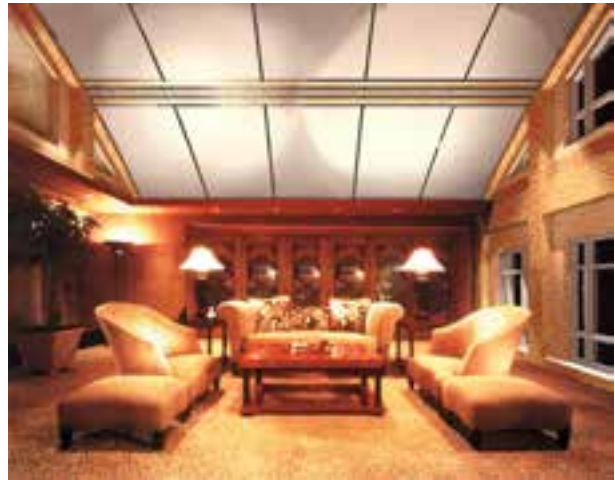
شکل ۱۴-۲. این شکل با استفاده از قواعد پرسپکتیو یک نقطه‌ای رسم شده است. به نقطه‌ای گریز خطوط افقی دیوارها و پنجره‌ها و خطوط شیب‌دار سقف توجه کنید.
