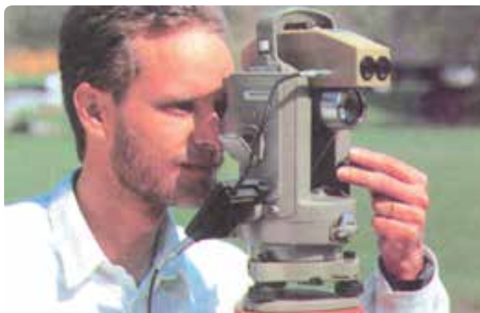
شکل ۴-۲۳- نصب فاصله‌یاب روی دوربین
